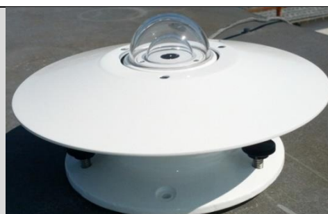
b. Piranómetro espectral de precisión Eppley (PSP)
