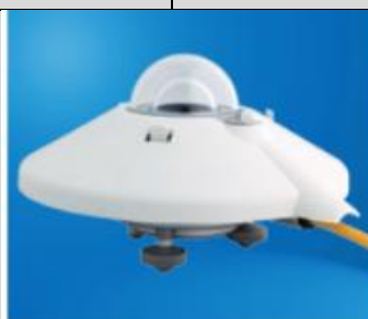
c. Piranómetro CMP11 (Fuente: Thies Klima)
